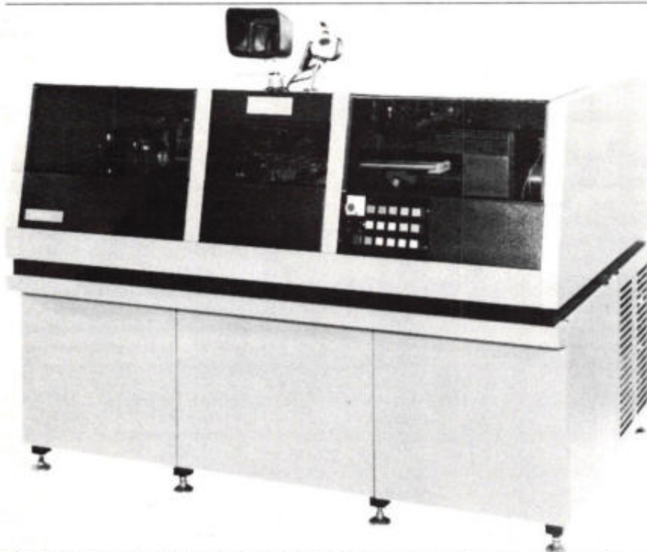
RMyMAS II van Universal Instruments. De RHyMAS is een „in-line“-machine en kent configuraties tot 20 plaatsingskoppen waarmee een totale capaciteit van 30 000 componenten per uur bereikbaar is.
