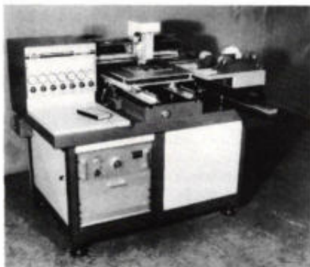
Dyna/Pert's SMA-machine MPS 118 heeft een verwerkingscapaciteit van 2000 componenten per uur, op substraten van maximaal 45 x 45 cm.
